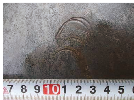
No.6 的补充：在加工装置的模具上存在损伤的示例
