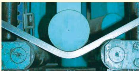
折弯试验的形状 (JIS Z 2248)
