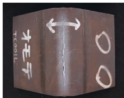
折弯加工时发生裂纹的示例
